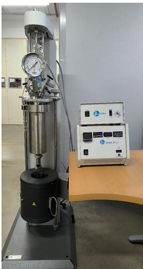
Imagen 13. Reactor de 2 litros de acero inoxidable (Biometa)
