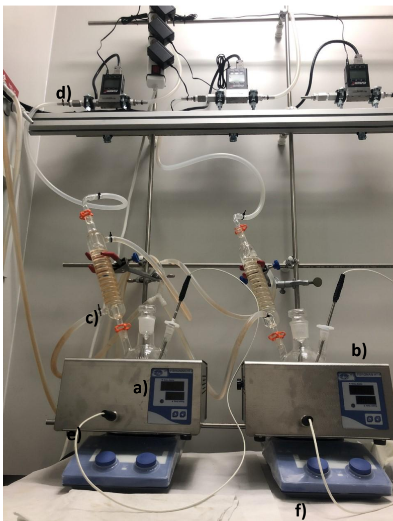
Imagen 16. Set-up sistema de deshidrogenación en detalle: a) Matraz de tres bocas o reactor; b) Thermopad; c) Serpentin o refrigerante; d) MFM; e) Manta calefactora; f) Placa calefactora/agitadora.
