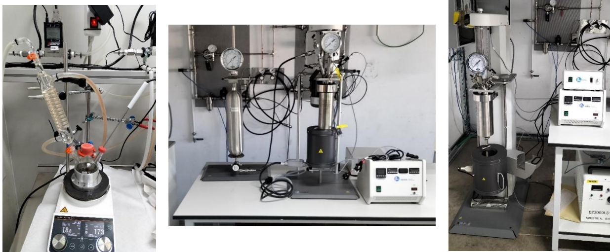
Imagen 17. Prototipos implementados para las reacciones de deshidrogenación/hidrogenación a diferentes volúmenes de reacción: 250 mL (izquierda), 600 mL (centro) y 2 L (derecha).
