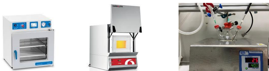
Imagen 24. Instrumentación empleada en la síntesis de catalizadores (de izquierda a derecha): Estufa a vacío, horno y sistema de reducción.
