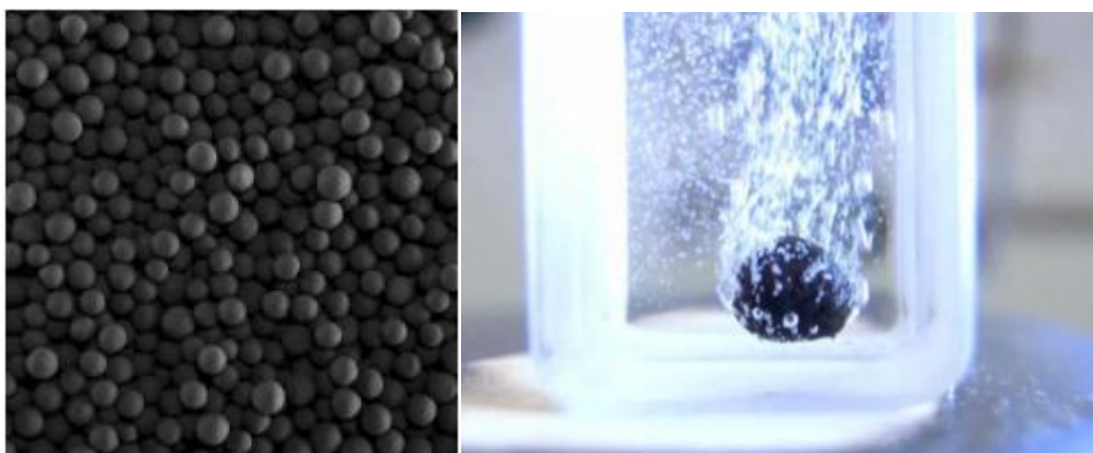
Imagen 10. Izquierda: Imagen de varias esferas del catalizador EleMax® de Clariant para LOHC. Derecha: Imagen del catalizador durante el proceso de deshidrogenación de 18H-DBT.
