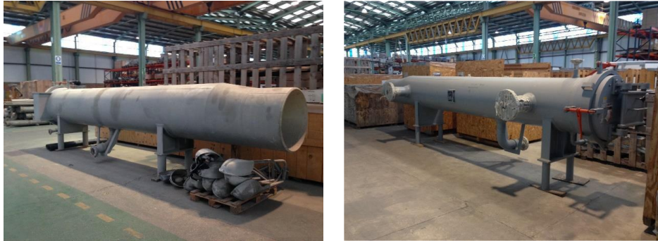
Fig. 2.- Equipamiento de gasoducto disponible en los almacenes de Enagás (trampa de rascadores) como propuesta de cámara de seguridad para los ensayos (equipo certificado para su uso a presión).
