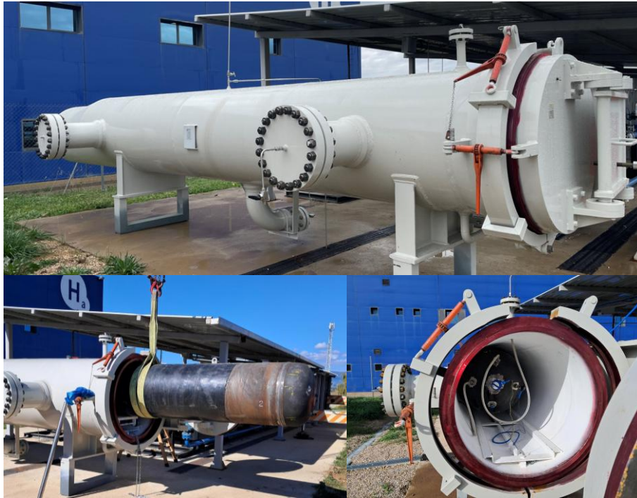
Fig. 3.- Instalación de ensayos de envejecimiento acelerado de un carrete de tubería aplicando ciclos de presión con hidrógeno.
