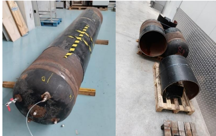
Fig. 13.- Carrete de tubería del material de 26" envejecido (equivalente a 1,37 años de operación) mediante los ciclos de presión/descompresión. Mecanizado de la tubería para extraer las probetas a ensayar.
