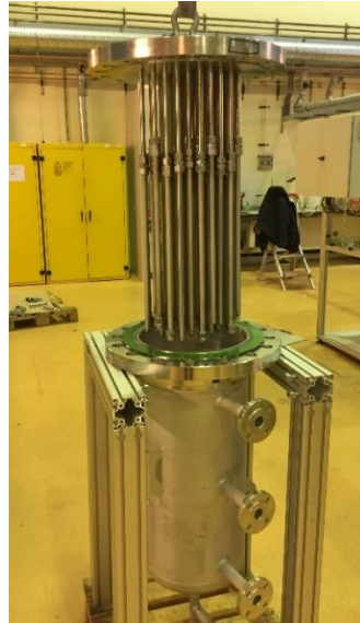
Fig. 3.- Imagen de un módulo de membranas densas de recuperación de H 2 .
